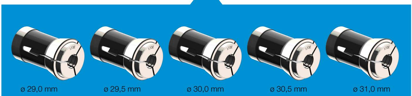
Kleštiny Rubber-Flex® RFC, patří do skupiny kleštin tlačných. Oproti ocelovým kleštinám mají větší upínací rozsah, což zajišťuje pružné spojení pryže a kovu a umožňuje tak upínací rozsah  $\pm 1 \text{ mm}$  na jmenovitý průměr. Lze tak šetřit nejen investici do čtyř ocelových kleštin, ale také se zkracuje doba výměny. Předem opracované nebo citlivé obrobky jsou přesně upnuty v kleštinách Rubber-Flex® RFC s hladkým otvorem.
